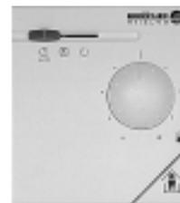
Raumfühler mit Partyschalter und Präsenztaste. Änderung der Raumtemperatur um  $\pm 3$  K und für die vorübergehende Umschaltung in die abgesenkte Betriebsweise.
