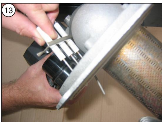
13 Bei Bedarf Elektrodenblock und / oder Brennerisolierung austauschen
