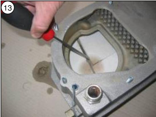
13 Rückwandisolation des Wärmetauscher mit einem Schraubendreher anheben und wie beschrieben entfernen
