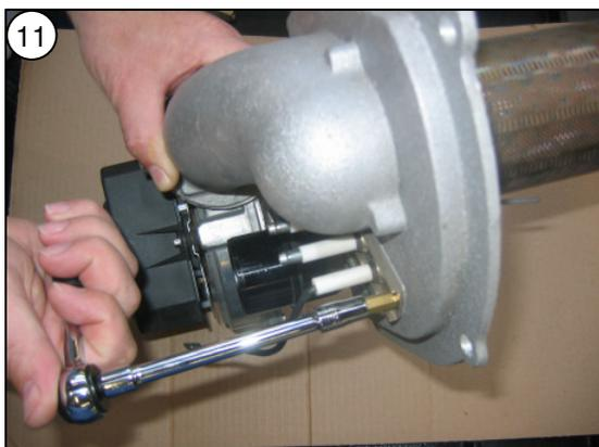
11 Zünd- und Ionisationselektrodenblock ausbauen, Brenner auf Verunreinigung und Beschädigung prüfen
