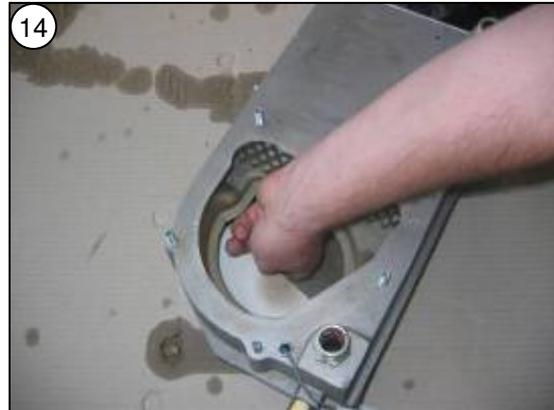
14 Rückwandisolation aus Wärmetauscher entfernen. Reihenfolge: 1. unten links, 2. unten rechts, 3. oben
