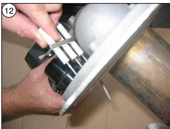
Bei Bedarf Elektrodenblock und / oder Brennerisolierung austauschen
