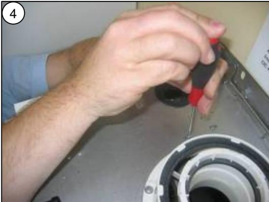
4 Schrauben für den Halter des Wärmetauschers von oben lösen, Halter von vorne herausnehmen
