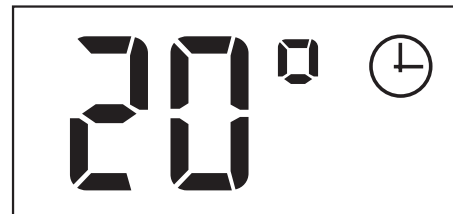
Gemessene Raumtemperatur (während des Automatischen Tagbetriebs)
