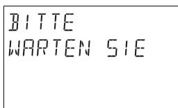
Der Reset wird durchgeführt. Im Display blinkt für ca. zwei Minuten „Bitte warten Sie“.
