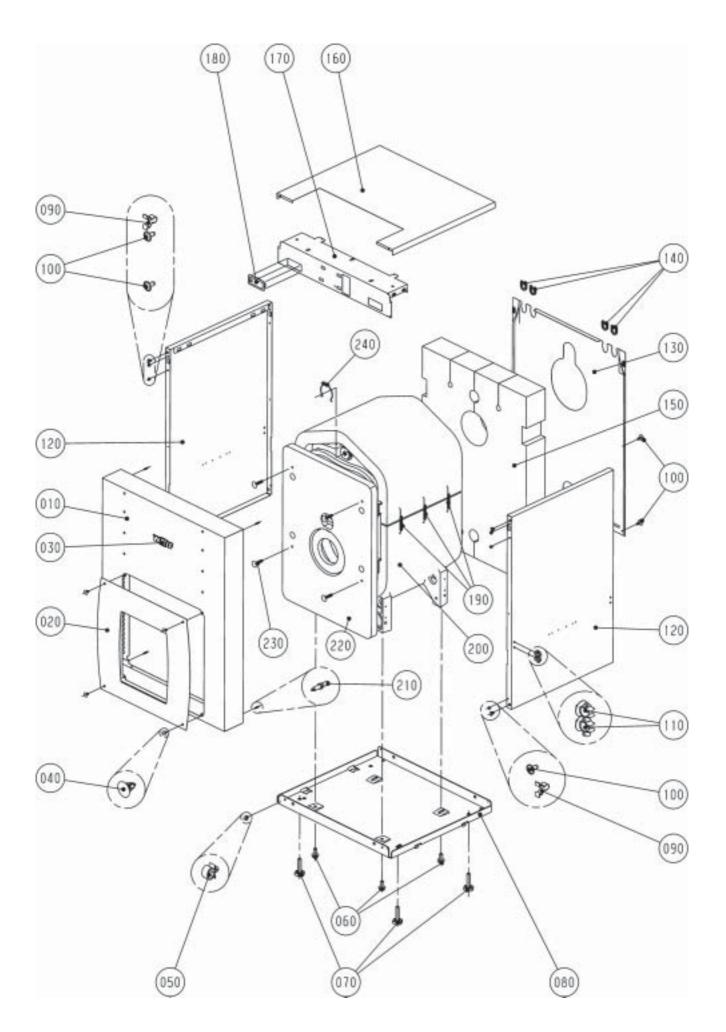
Verkleidung und Isolierung CHU 60 KW
