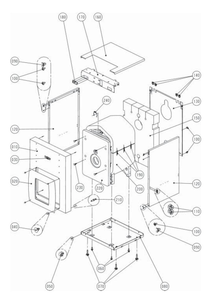
Verkleidung und Isolierung CHU 37 KW
